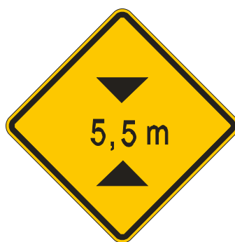
Figura144 – Sinal A-37 – Altura limitada
