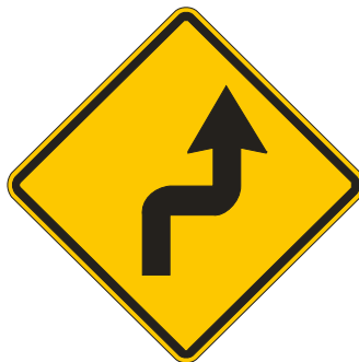
Figura 91 – Sinal A-4b – Curva acentuada em “S” à direita
