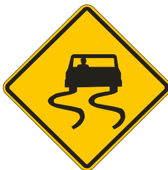
Figura124 – Sinal A-28 – Pista escorregadia
