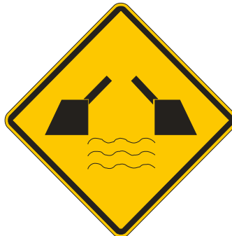
Figura140 – Sinal A-23 – Ponte móvel
