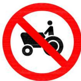
Figura 71 – Sinal R-13 - Proibido trânsito de tratores e máquinas de obras
