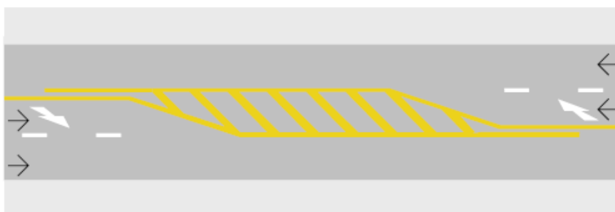
Figura 246 – Alternância no número de faixas de trânsito destinadas a cada sentido de circulação
