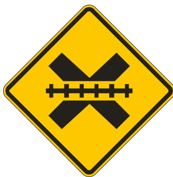
Figura141 – Sinal A-39 – Passagem de nível sem barreira
