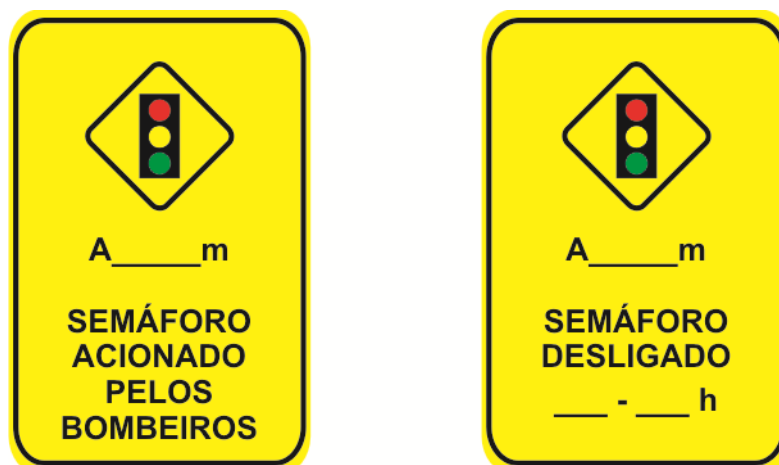
Figura 4.22: Exemplo de sinalização de advertência a ser localizada em seção anterior à interseção
